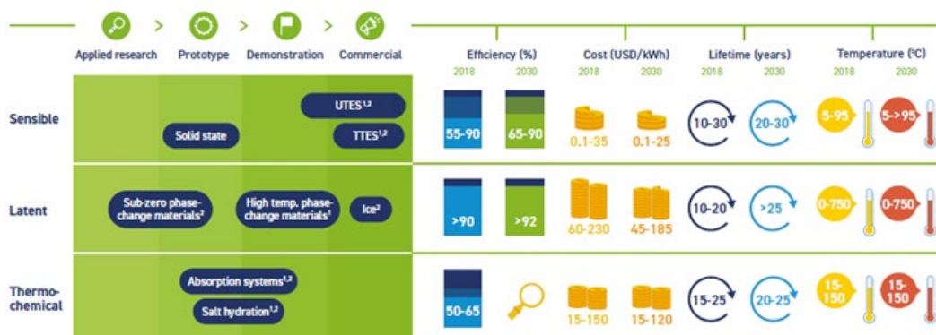
図 II-23 地域熱・冷熱供給における蓄熱材の開発状況と 2030 年の開発目標 (出典：IRENA, Innovation Outlook Thermal Energy Storage, 2020)
